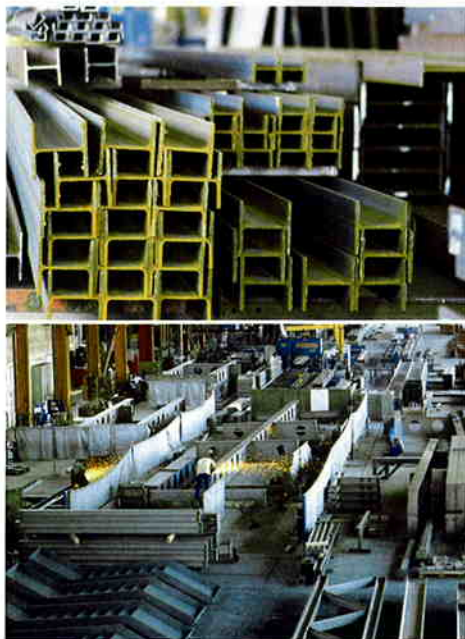
Dans l'atelier de construction des charpentes, poutrelles et plaques d'acier sont transformées en meccanos géants, soudés et boulonnés avec précision. Ces structures soutiendront les éléments de façades qui sont fabriqués dans la halle voisine, tout aussi vaste.
