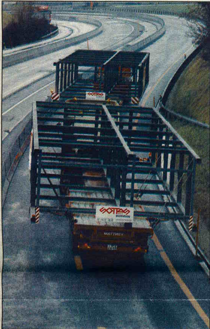
Du départ de Bulle à l'installation au centre de Lausanne, le convoi exceptionnel de l'entreprise Sottas méritait son superlatif, avec des structures métalliques de 5,3 m de large pour 18 m de long.
